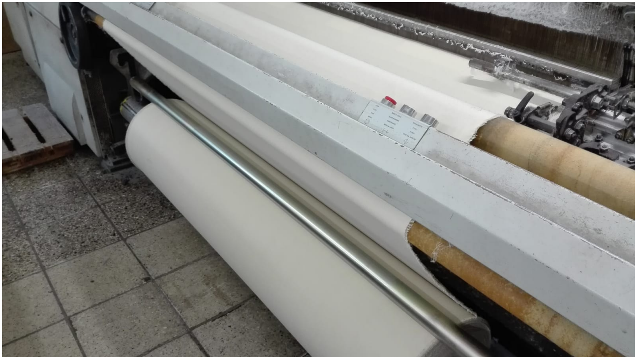
Abbildung 2: Vectrangewebe auf Greifer-Webmaschine -> rechts oben deutlich erkennbarer Faserabrieb am Webblatt und an den Webschäften
